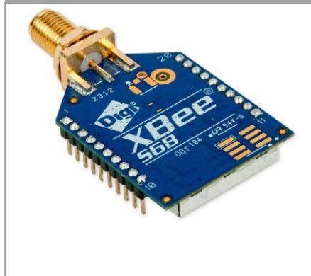
↑ Il modulo XBee
