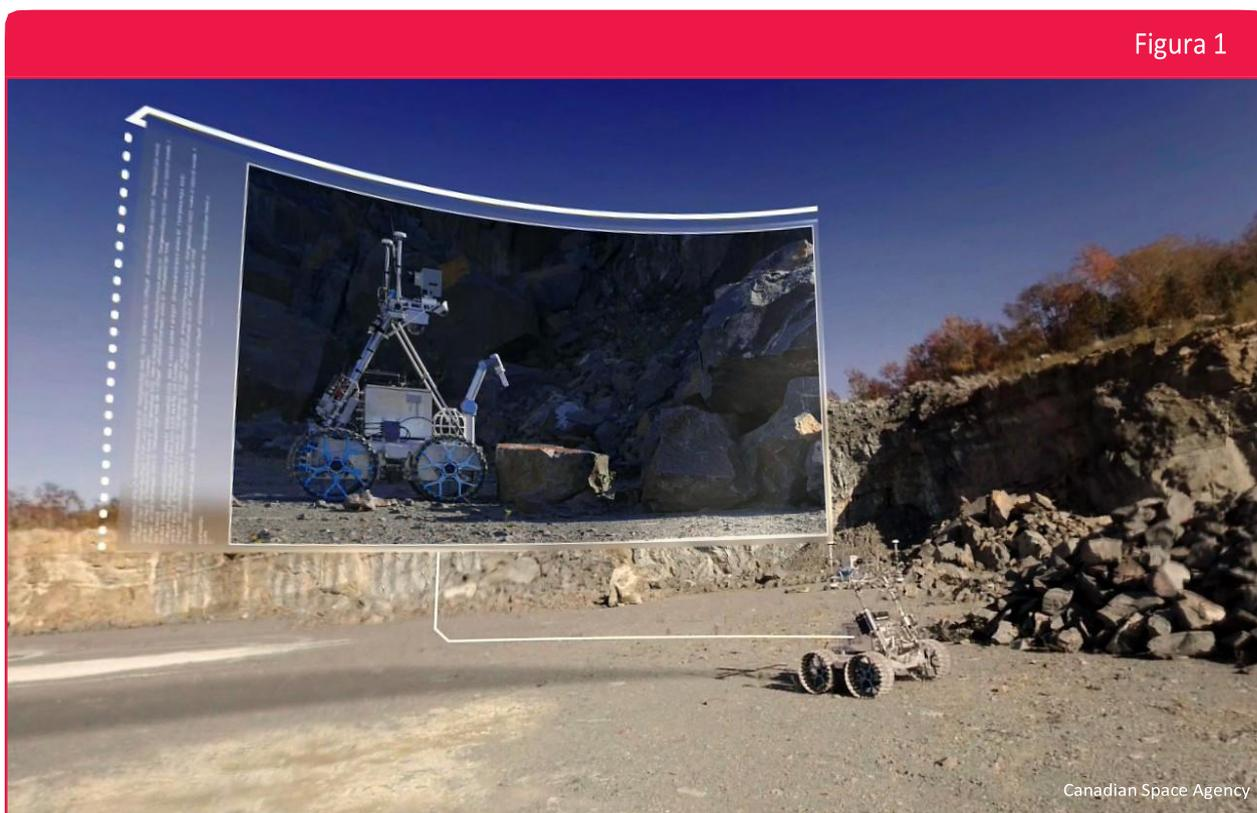
↑ Un prototipo di rover viene utilizzato per campionare una cava che assomiglia ad un sito lunare. L'immagine mostra una immagine virtuale del test.
