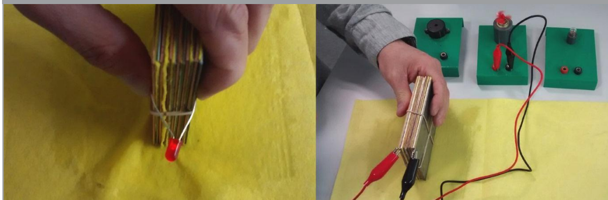
Figura 2: Far accendere un LED (sinistra) e far girare un motorino (destra) con la pila di Volta.
