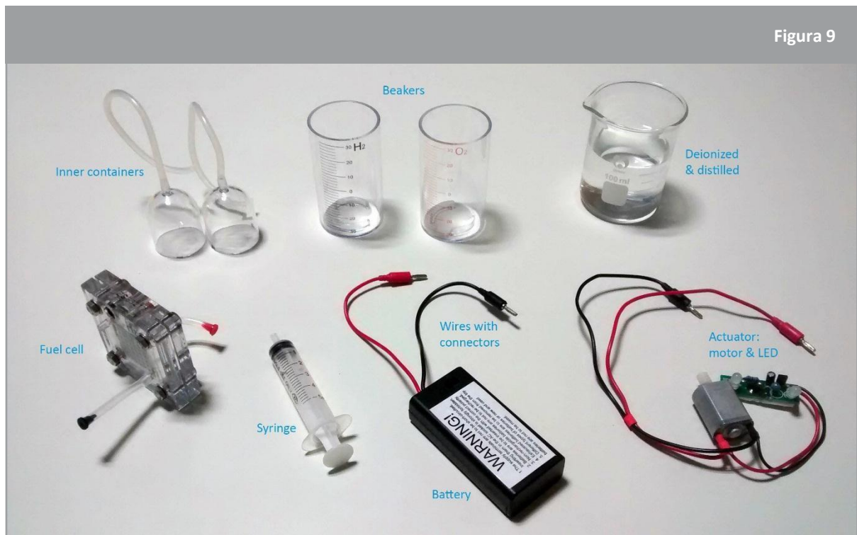
↑ Materiali necessari per costruire una cella a combustibile.
